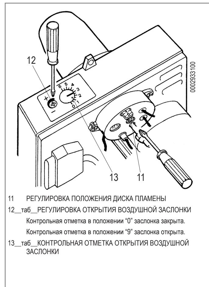
11 РЕГУЛИРОВКА ПОЛОЖЕНИЯ ДИСКА ПЛАМЕНЫ
