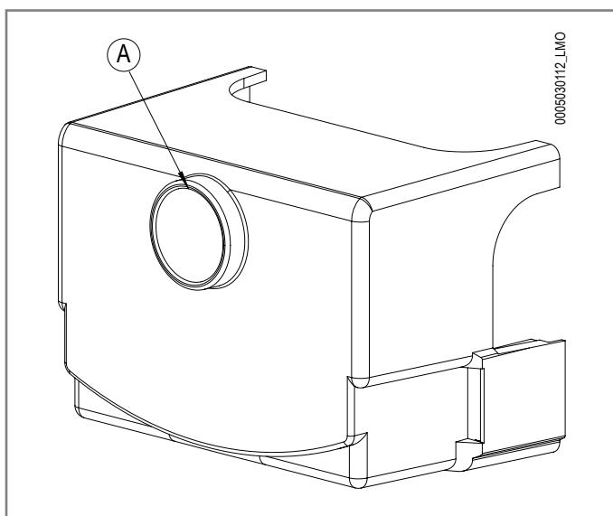
При нажатии и удержании ее в течение более 3 сек., будет активирована фаза диагностики (красный свет с быстрым миганием), в приведенной ниже таблице указывается причина блокировки или неисправности в зависимости от количества миганий (также светом красного цвета).
