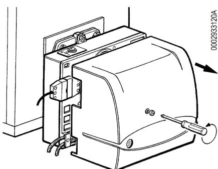
Отвинтите винт крышки, чтобы обеспечить доступ к внутренним частям горелки.
