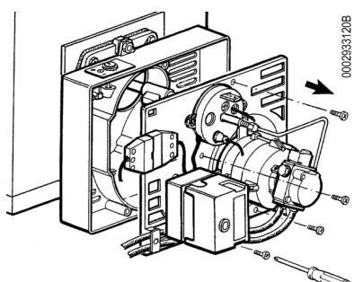
Раскрутить четыре винта плиты, в соответствии с указаниями, чтобы получить доступ к форсунке, электродам и подогревателю при его наличии.
