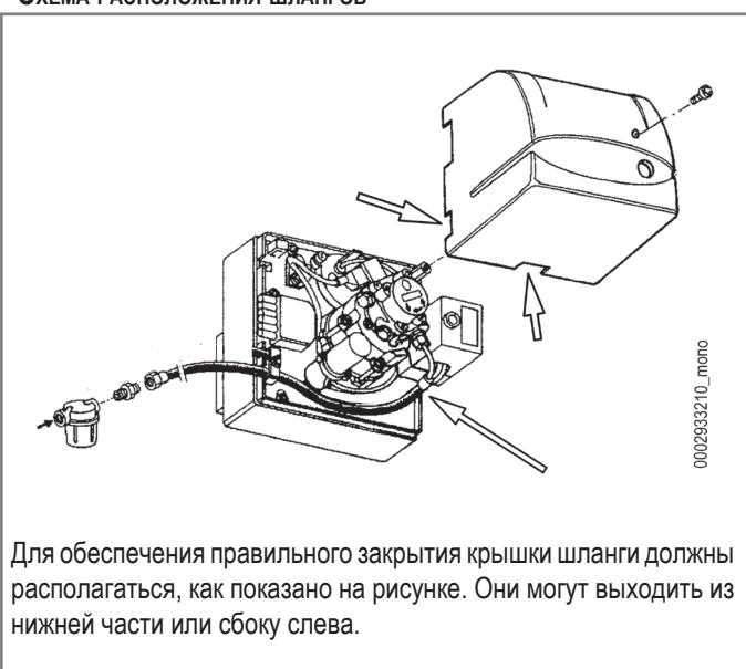
Для обеспечения правильного закрытия крышки шланги должны располагаться, как показано на рисунке. Они могут выходить из нижней части или сбоку слева.
