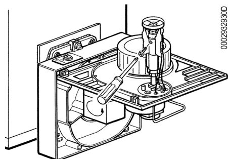
Чтобы демонтировать форсунку, следует снять вначале диск электродов, вывинчивая винт.
